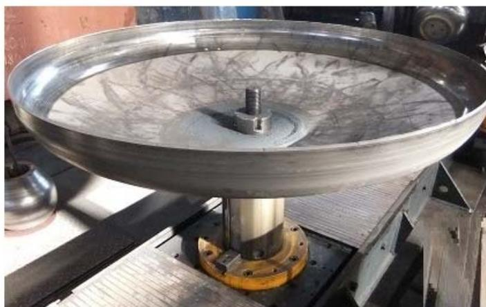
Эллиптические днища, торосферические днища и эллиптические заглушки благодаря рациональной форме и надежности в работе получили широкое применение при производстве сосудов, аппаратов, резервуаров и емкостей, работающих под давлением. При производстве оборудования в России и Европе использовались разные типы днищ: в России - эллиптические, в Европе - торосферические. Сегодня, с появлением доступного оборудования и технологий для изготовления торосферических днищ, мы применяем оба типа днищ.
