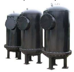
Фильтр ФИПа 1 ионитный параллельноточный первой ступени используется на водоподготовительных установках электростанций, промышленных и отопительных котельных и предназначен для обработки воды с целью удаления из нее катионов накипеобразователей ( Ca2+ и Mg2+ ) в процессе натрий-водород-катионирования или аммоний-натрий-катионирования, а также сульфатных, хлоридных и нитратных анионов в процессе обессоливания природных вод.
