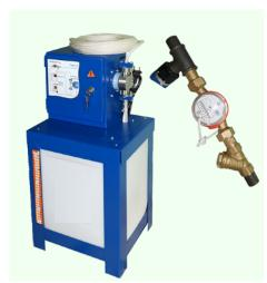
Автоматическая система дозирования реагентов (АСДР) Комплексон-6 предназначена для обработки воды, поступающей в системы теплоснабжения, ГВС и ХВС ингибиторами (реагентами).
