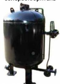
Солерастворитель предназначен для приготовления раствора поваренной соли и сульфата аммония, очистки его от механических примесей и подачи для проведения регенерации катионитных фильтров в промышленных и отопительных котельных.
