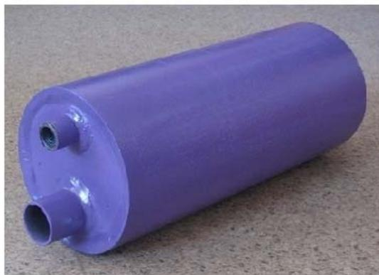
Воздухосборник ВСГ и воздухосборник ВСВ предназначены для улавливания из потока и отведения пузырьков воздуха. Применяется в системах вентиляции, отопления и теплоснабжения для предотвращения образования воздушных пробок и гидравлических ударов в трубопроводах.
